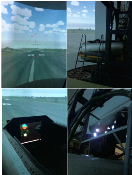
Пилотажный стенд ТМК-2. Сферическая 8-и канальная система визуализации внекабинной обстановки с углами обзора 140° x 90°
